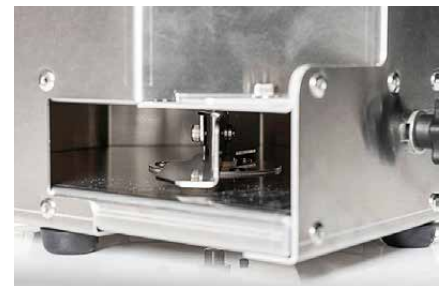
Die Streuscheibe befindet sich unterhalb eines Zwischenbodens. Selbst bei vollem Behälter läuft sie dadurch immer leicht an.
