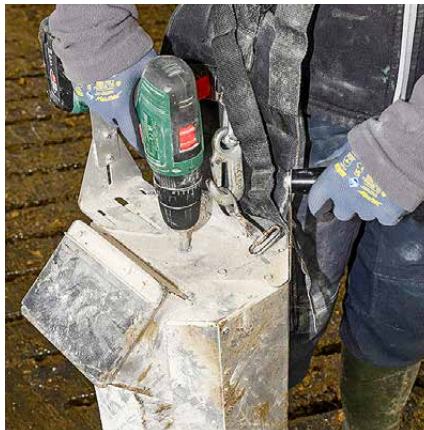
Der Akkuschauber sitzt auf der 10er Rührwelle. Zum Halten gibt es einen Handgriff.
